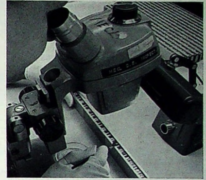
Bild 11. Kontrolle der Verbindung mit der Grundplatte
